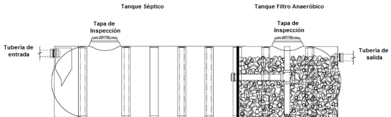
Figura 4. Tanque Séptico Avícola Duchas y Unidad Sanitaria Ingreso de la Granja
